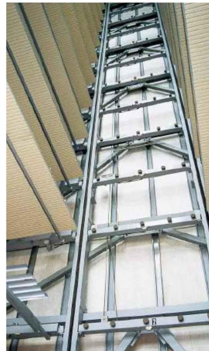
富士変速機と大学の研究センターにおいて、当社の立体駐車装置「パズルタワー」へ地震圧力を作用させると、その独自のトレイの横行装置により高い免震効果を発揮することが確認されました。また、一般エレベータ方式(パレット式)に比べパズルタワーは、滑動・揺動による免震効果が顕著に現れることが判明しました。
