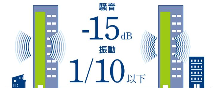
車を動かす1台分のギヤードモータの容量は小さく、くし歯式のため運動量も最小限に抑えられているので騒音、振動が少なく、ビルへの組み込みが可能です。
