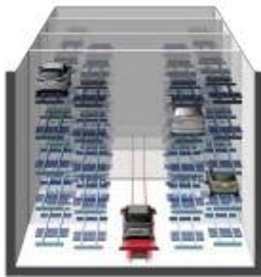
各列にリフトを配置し、地下に走行台車をプラスし、パズルタワーの「くし歯」方式を最大限応用したエレベータ方式の駐車場が「スーパーパズルGS」です。
